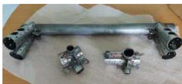
Les **ferrures préassemblées**, fournies par le Cercle des Machines Volantes et destinées à relier les couples aux longerons, ont été soudées au laser par le lycée La Découverte (Decazeville - 12). Ce travail a permis de fournir **les 64 ferrures** nécessaires aux cadres avant et arrière, un ensemble indispensable à la cohérence structurelle du fuselage.
